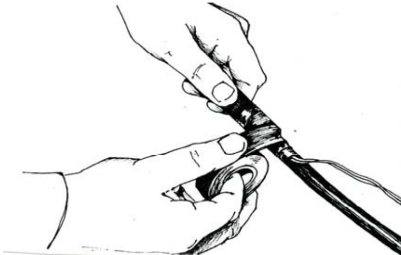
Рис. 3.3. Обмотка проволочного бандажа лентой 88Т
