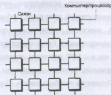
Рис.3.1. Схема соединения процессоров в виде плоской решетки
