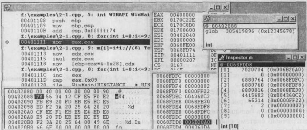
Рис. 2.17. Поиск глобальных и локальных переменных в окнах процессора
